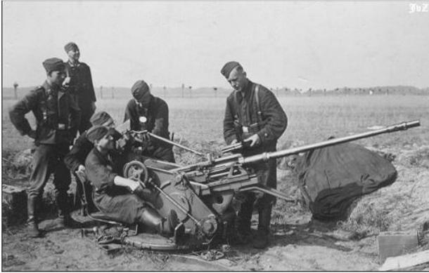
Figure 9 – Photographie d'un canon de 20mm Flak 30 tchèque. Bien que cette photographie fut prise en Pologne, le canon utilisé sur la casemate nord de Kondor était en tous points identique, y compris sa fixation sur le sol. Un autre modèle de Flak 30, identique et beaucoup plus commun, est monté sur deux roues afin d'être remorqué. Date de la photographie inconnue.
